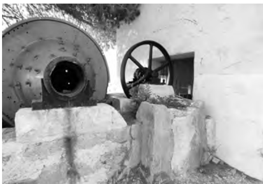
Ilustración 20. Molino de bolas del Lavadero El Ferrocarril colocado en el Lavadero de Remunerada
